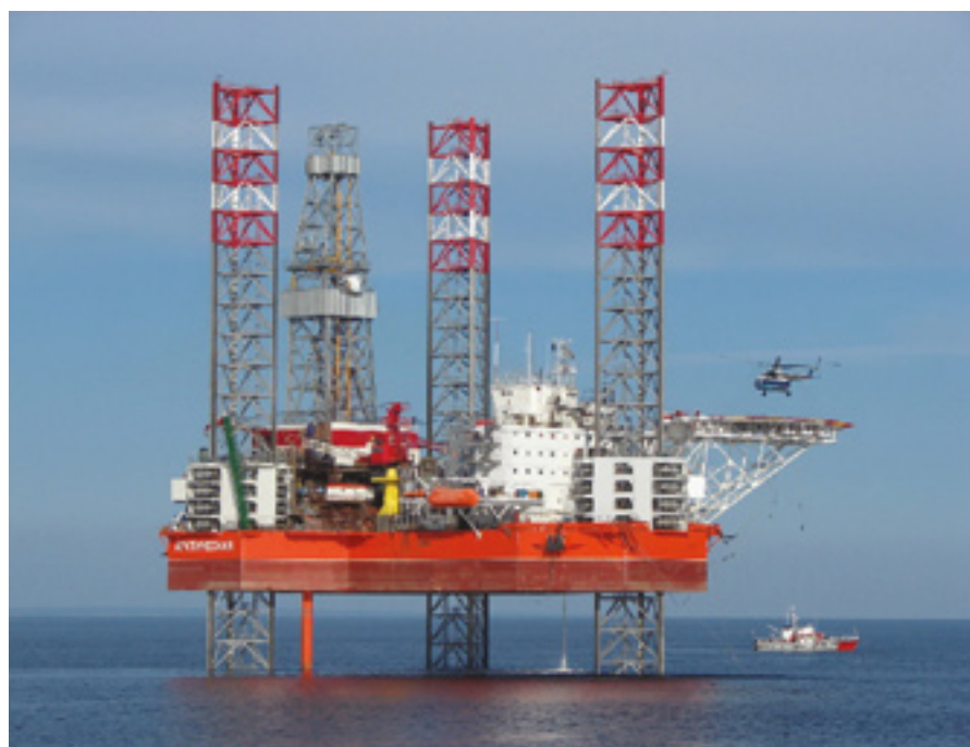
Самоподъёмная платформа для Арктических морей
